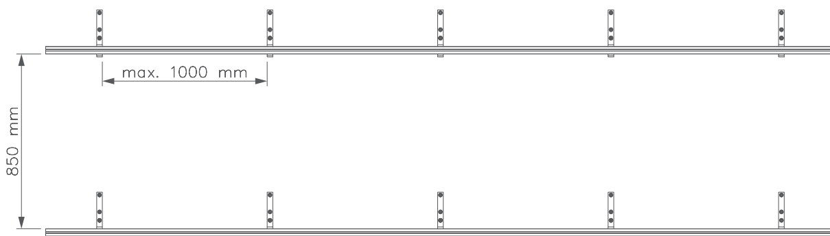
Rys. 2. Rozmieszczenie szyn montażowych wraz z uchwytem dachowym
